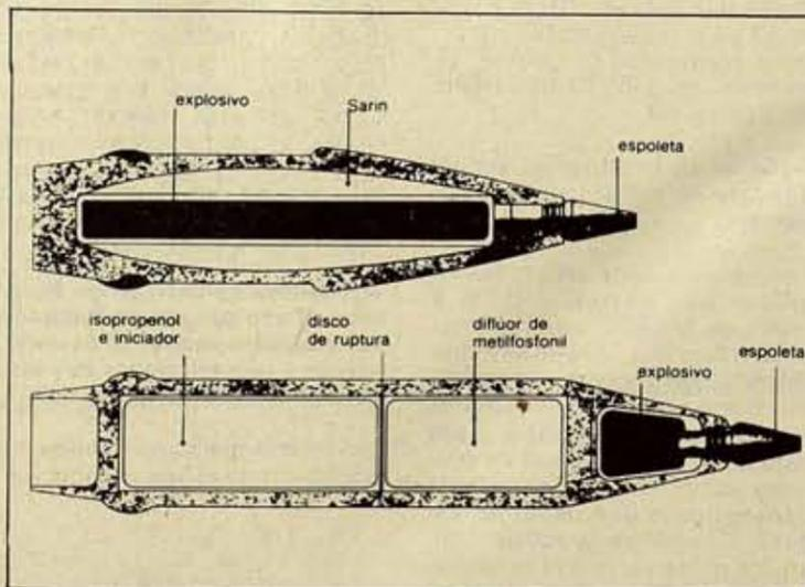
Estos dos obuses de artillería norteamericanos de 155 mm están diseñados para transportar el gas neurotóxico llamado sarin. El primero es una munición convencional, mientras que el segundo es la nueva arma binaria. Está compuesta por dos sustancias poco nocivas, aisladas en dos compartimentos diferentes. Cuando se produce la explosión, el opérculo que las separa se rompe, los dos compuestos se ponen en contacto y su mezcla produce el gas neurotóxico.
